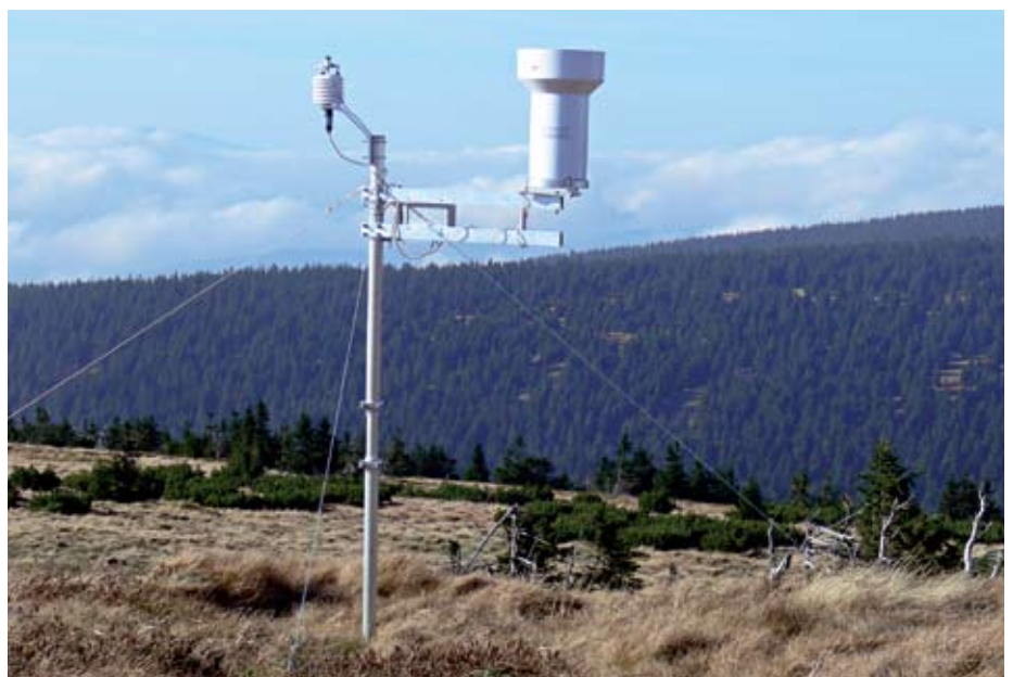
Terénní meteorologická stanice pro sledování mikroklimatických charakteristik v lokalitě Petrovy kameny.
